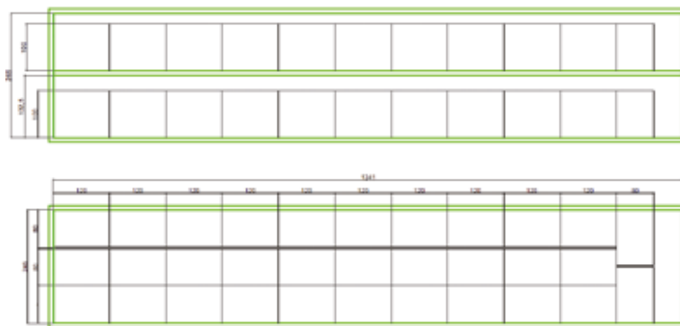
Rys. 5. Przykład rozmieszczenia palet euro w dwupoziomowym systemie załadunku naczepy ciężarowej
